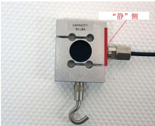
对于拉力测试，将拉力适配器固定在与“静”侧相对的另一端。连接“静”侧与测试仪。
