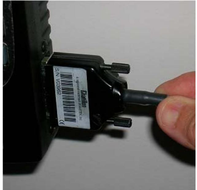
切勿通过拉电缆来断开传感器。这将会损坏连接。抓住接头并将其从接头外壳上拉出。
