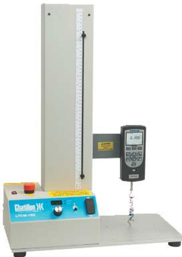
图示：安装在 LTCM-100 移动式测试仪上的 DFS II 推拉力计
