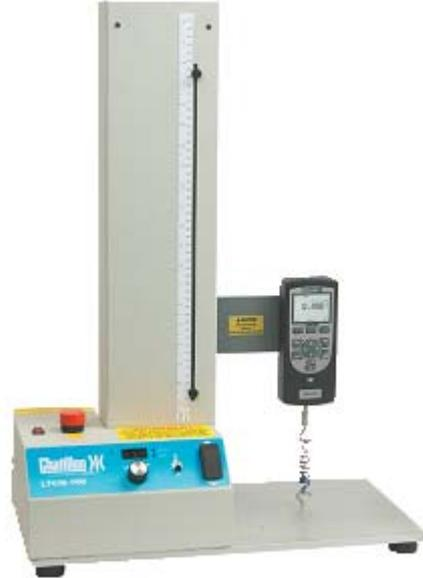
安装在 LTCM100 测试仪上的 DF II 系列测力计
